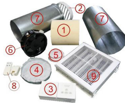
Рис. 1. Составляющие вентилятора-рекуператора: 1 — керамический рекуператор; 2 — уличная декоративная решетка; 3 — блок управления; 4 — фильтр; 5 — детектор дыма; 6 — осевой вентилятор; 7 — телескопический корпус устройства; 8 — пульт управления; 9 — внутренняя декоративная решетка с жалюзи
